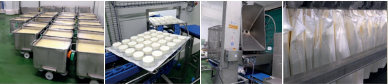
Le nouvel atelier, équipé par Tecnal, comprend cinq lignes de production, menées par deux équipes, qui convergent vers la salle de conditionnement. L'une est dédiée au moulage à la louche. L'atelier fonctionne avec des lignes de bassines carrées de 180 litres. « Toutes sont montées sur roulettes, pour éviter des chariots à l'intérieur. Il n'y a pas
